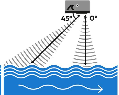
Der All-in-One-Radarsensor, der erstmals Geschwindigkeit und Wasserstand in einem kompakten Gerät vereint. In einem Gehäuse von unvergleichlicher Kompaktheit und gleichzeitig unübertroffener Robustheit. Maximale Messentfernung: 20 m
