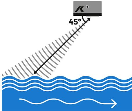
Der HyQuant V Sensor von KISTERS nutzt die Doppler-Technologie im 60-GHz-Frequenzband, um die Fließgeschwindigkeit an der Wasseroberfläche präzise und kontaktlos zu messen. HyQuant V verfügt über einen kleinen und leicht zu installierenden IP68-Sensor mit einem engen Öffnungswinkel, hohe Genauigkeit und vorinstallierten Filteralgorithmen. Maximale Messentfernung: 20 m
