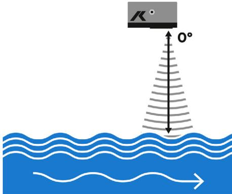
Der Sensor HyQuant L von KISTERS nutzt die FMCW-Technologie im 60-GHz-Frequenzband zur kontaktlosen Wasserstandsmessung. Der HyQuant L Radarsensor für Wasserstandsmessungen ist kompakt, leicht und IP68-klassifiziert. Er verfügt über einen engen Öffnungswinkel, hohe Genauigkeit und integrierte Filteralgorithmen. Erhältlich in zwei Messbereichen:
